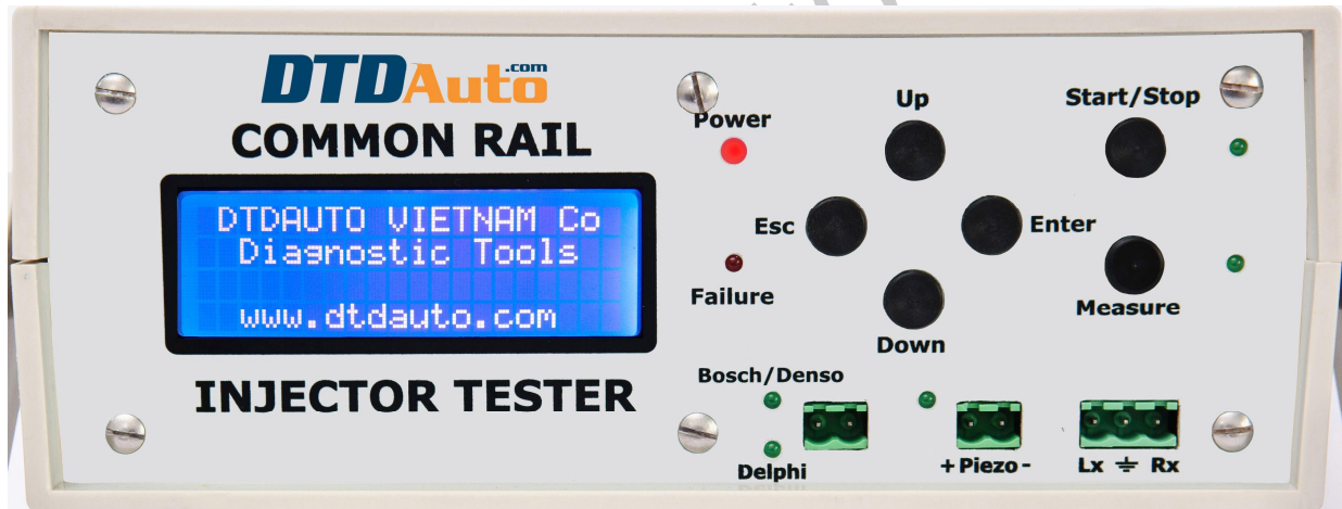
Mặt trước bộ điều khiển kim phun
